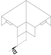
**Flachwinkel schnittkaschierend aus Stahlblech zu LFS 60x100mm verkehrsweiß**
