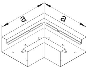
**Flachwinkel aus Grundprofil BRS 68x210mm Oberteil 80mm Stahlblech verkehrsweiß**
