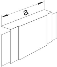
**T-Stück aus Kunststoff halogenfrei zu LF/LFH 60x90mm lichtgrau**
