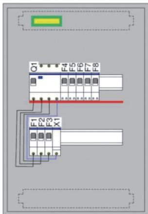
**Wohnungspaket, Volta, anschlussfertig mit 1 FI-Schalter (G/A) und LS 1+N**
