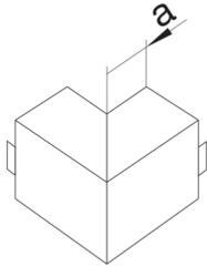
**Außeneck schnittkaschierend Stahlblech LFS 40x60mm verzinkt**
