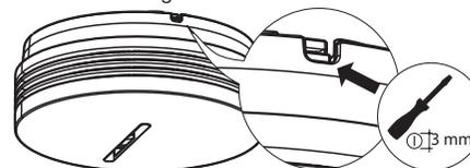
2. Melder von der Halterung abnehmen, indem er gegen den Uhrzeigersinn gedreht wird.
