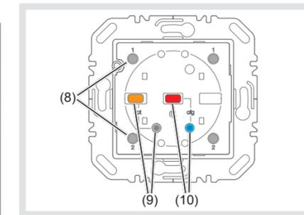
Bild 2a: Bedienelemente der Funk Taste 1-fach
