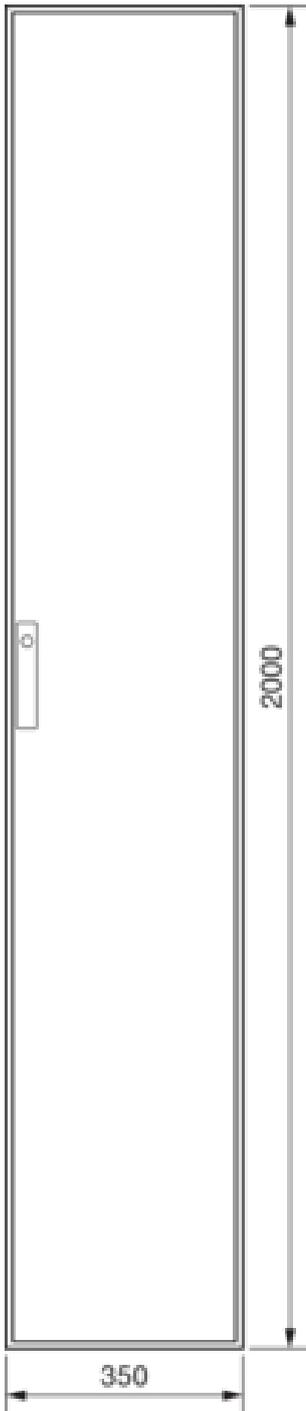
**Anreihstandsverteiler IP41 350x2000x600 120° RAL7035 Rückwand verzinkt**
