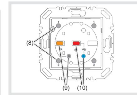
Bild 2a: Bedienelemente der Funk Taste 1-fach
